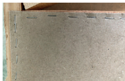
Grapado mueble. Disparo tiro a tiro. Agrafagem de móveis. Tiro a tiro.
